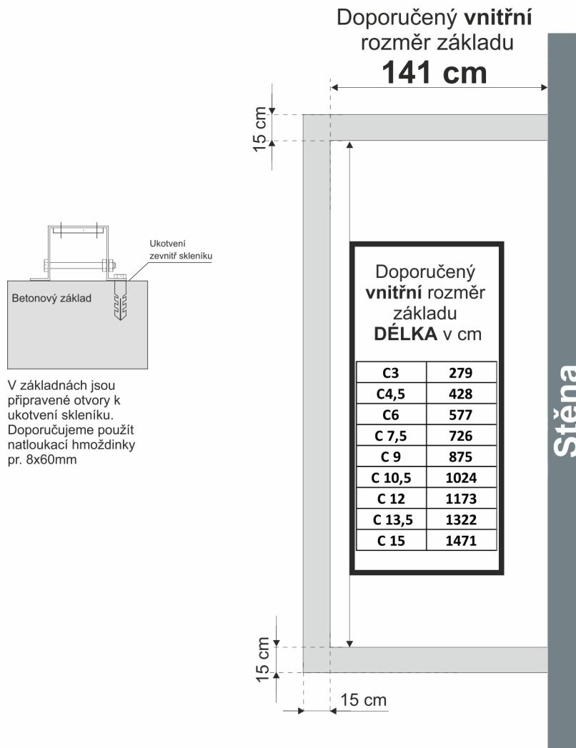
V základních jsou připravené otvory k ukotvení skleníku.
