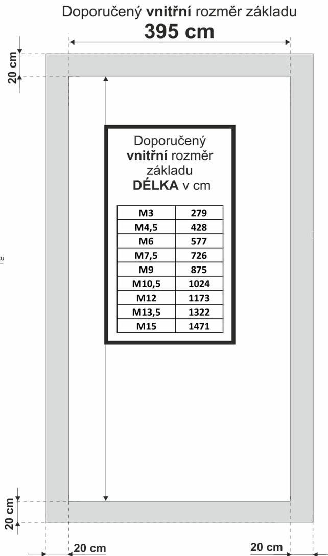
V základnách a výztuhách jsou připravené otvory k ukotvení skleníku. Doporučujeme použít natloukací hmoždinky pr. 8x60mm
