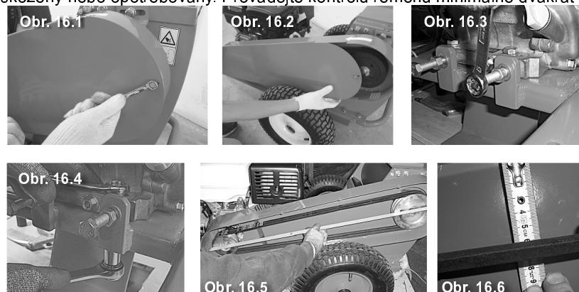
Všimněte si, že jakmile budou řemeny sejmuty, můžete snadno provést kontrolu vzdálenosti mezi noži a protilehlým nožem, protože se rotor může volně otáčet.
